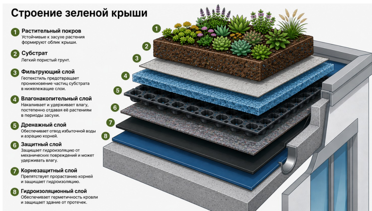
Рис. 3 — Строение зеленой крыши
