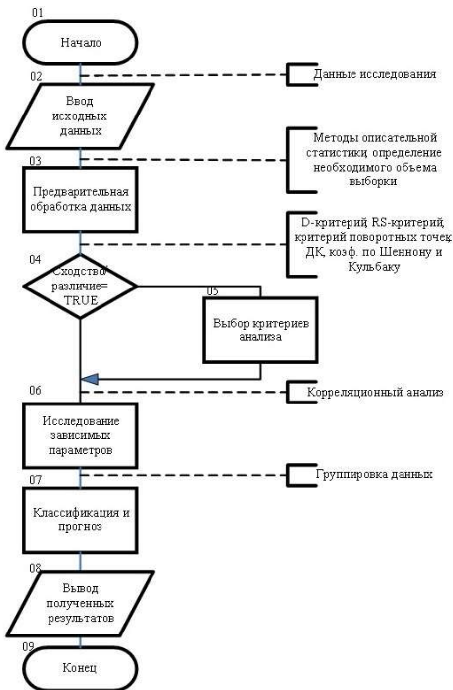
Рисунок 1 - Схема алгоритма выбора информативных параметров с использованием методов статистического анализа
