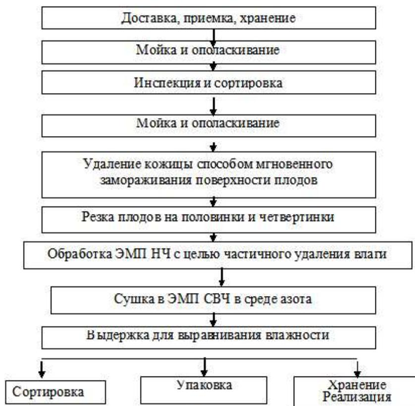
Рисунок 7 – Структурная схема производства сушёных томатов
